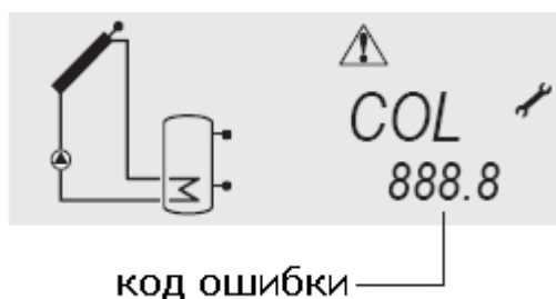
Рисунок 12 — Вид дисплея при ошибке датчика.
